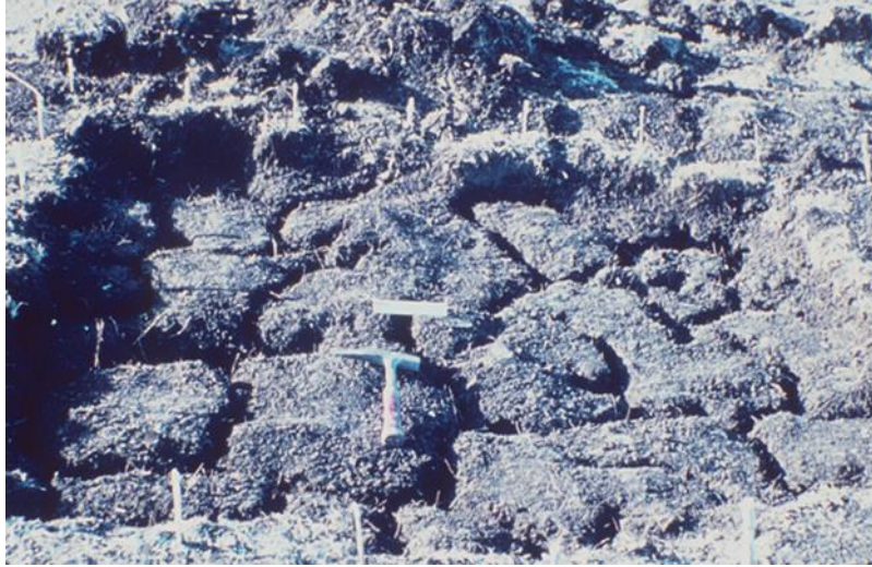
Figure B.1 Preuve typique de la présence de sols argileux expansifs
