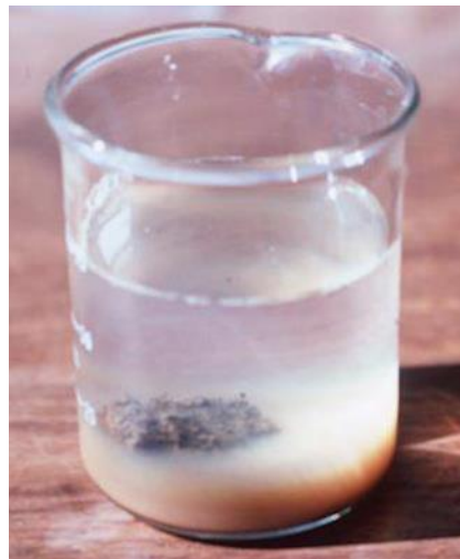
Figure B.4 Sol dispersif dans l'eau (test de miettes) montrant une suspension qui ne se dépose pas
