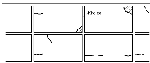
Hình 60 - Hai dạng hư hỏng chính của mặt đường bê tông xi măng
