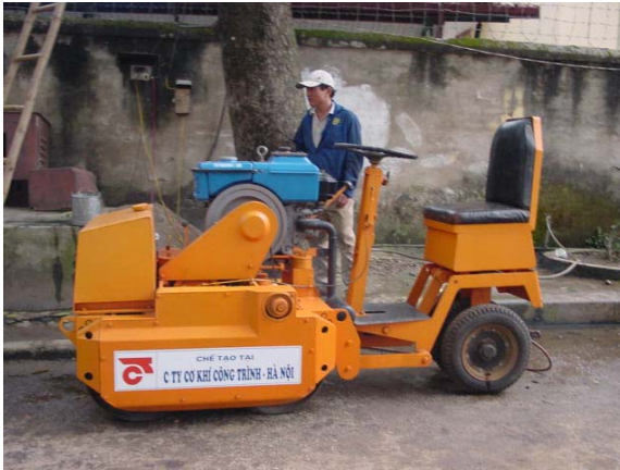
Hình 70 - Lu rung loại nhỏ CR 10A (1000 kg)
