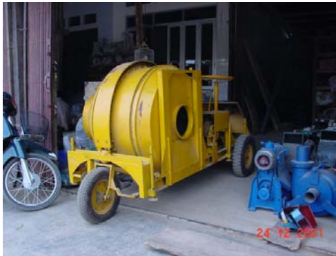
Hình 74 - Máy trộn bê tông loại nhỏ công suất 5m 3 /h
