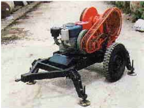
Hình 73 - Máy nghiền đá công suất nhỏ ( 5\text{m}^3/\text{h} )
