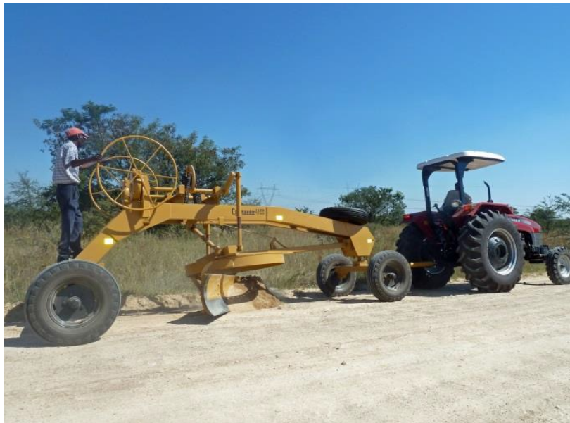
Niveleuse de 2 tonnes tirée par un tracteur, fabriquée au Zimbabwe (Photo : Rob Petts)
